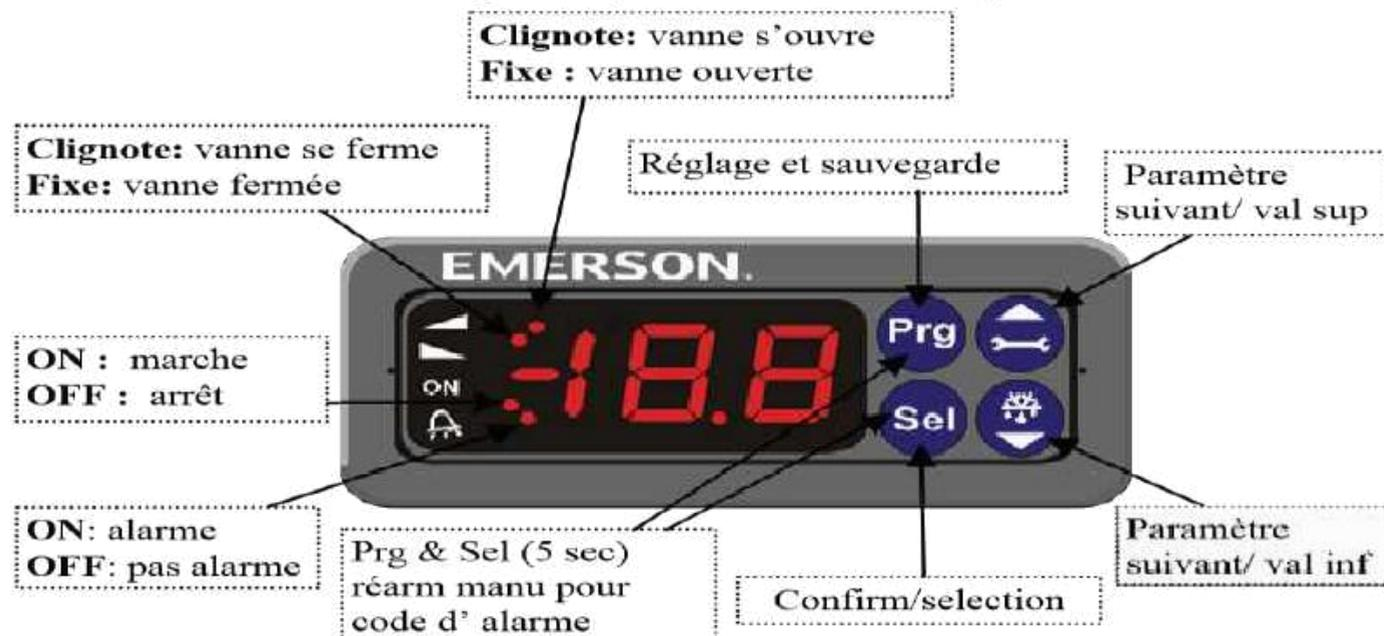
*Réarmement manuel : appuyer simultanément Prg & Sel (5 sec)*
